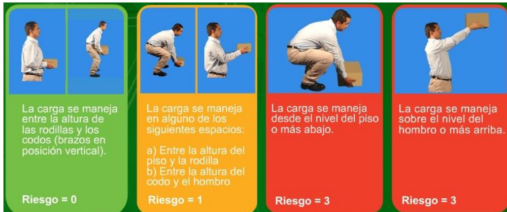
Figura 8. Recorrido vertical en la operación de levantamiento
