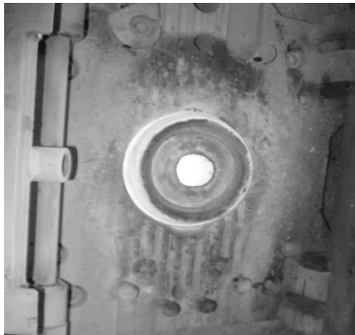
Figura 24. Desgaste del diámetro interno de la boquilla inferior
