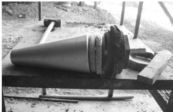
Figura 19. Mecanismo para instalación de tapón poroso
