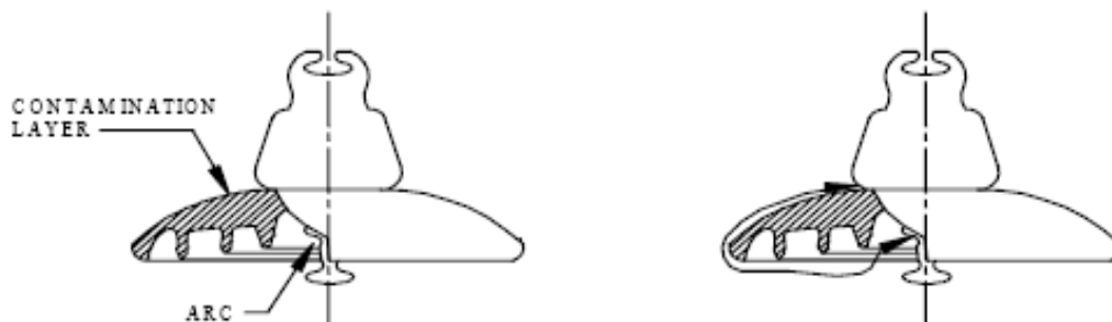
Figura 32. Efecto de una partícula de contaminación sobre el disco de aislamiento de suspensión
