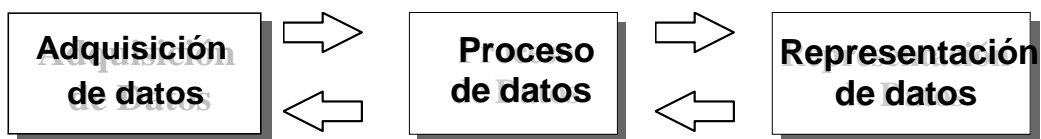
Figura 2. Elementos del sistema SCADA
