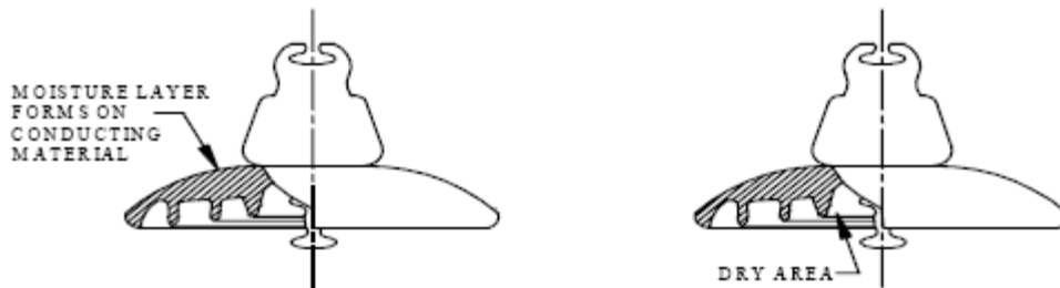
Figura 31. Efecto de la humedad en aislamiento de suspensión
