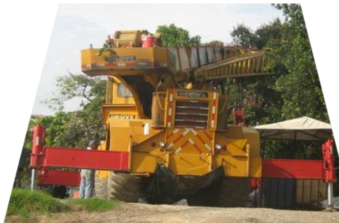
Figura 20. Nivelación de la grúa
