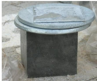
Figura 42. Shims colocados en posición
