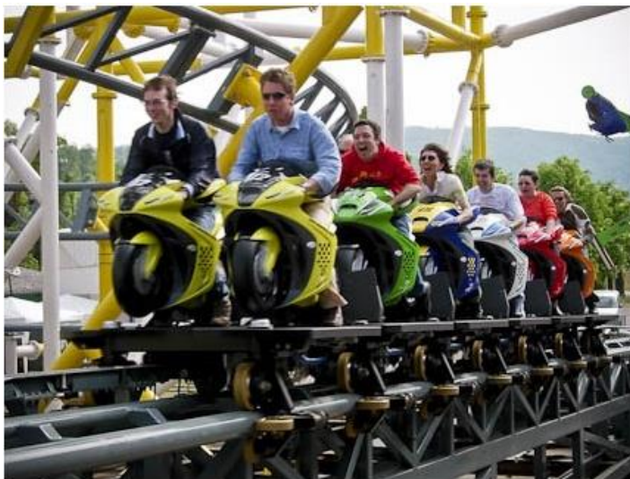
Figura 30. Se aprecia la colocación de las ruedas
