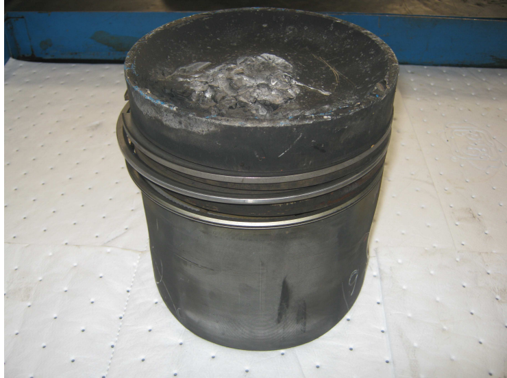
Figura 67. Pistón de motor 3508B con daño en la corona
