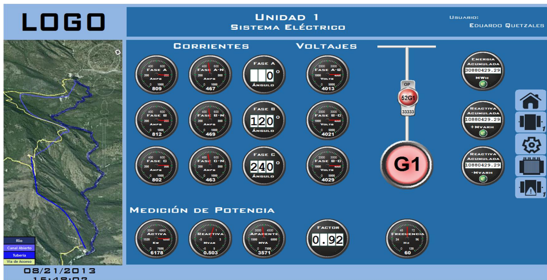
Figura 28. Vista del sistema eléctrico en el Sistema SCADA
