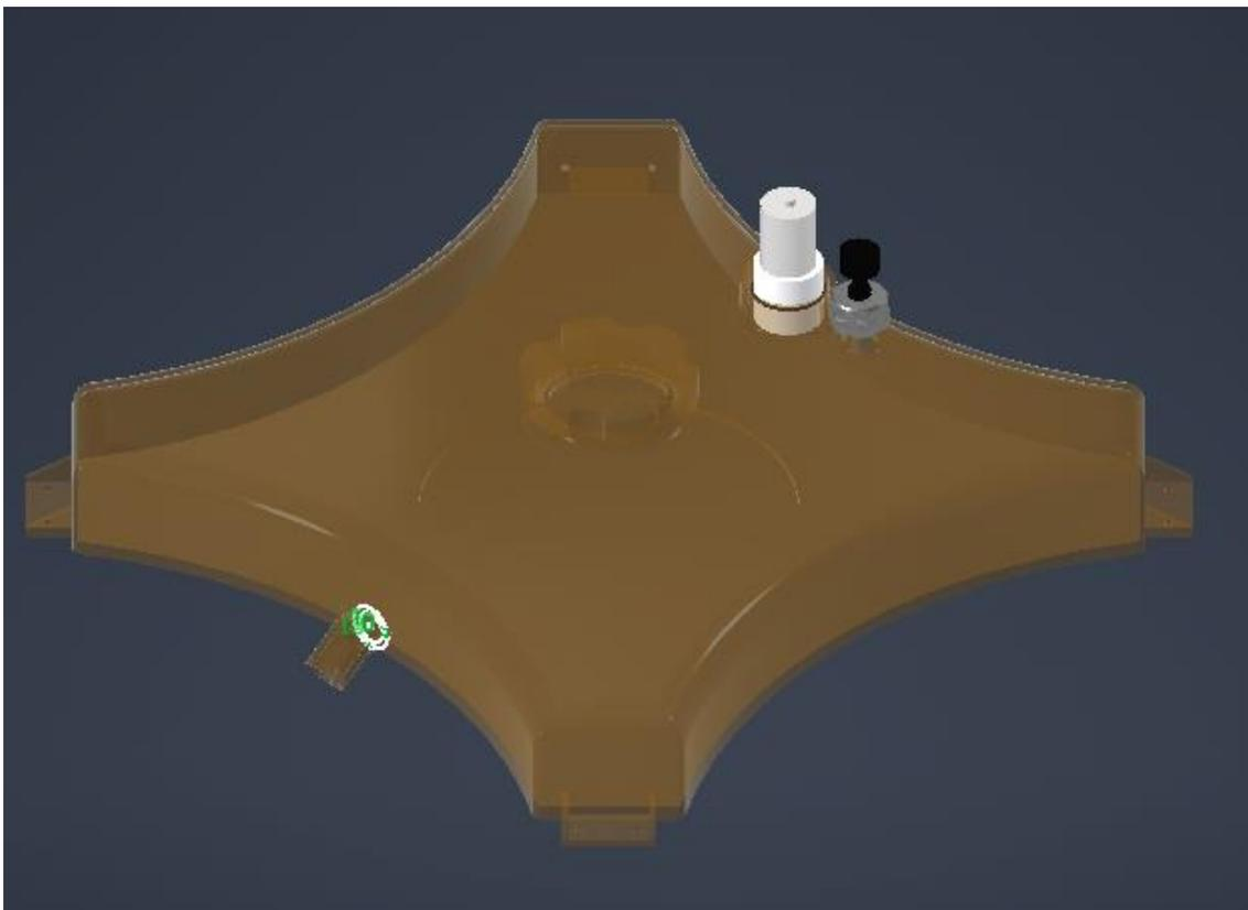
*Nota.* Diseño 3D de tanque para transporte de fertilizantes con ubicación de componentes electrónicos. Elaboración propia, realizado con Autodesk Inventor.
