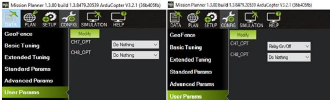
*Nota.* Configuración de canal de entrada para el control de Payload. Elaboración propia, realizado con captura de pantalla de Windows.
