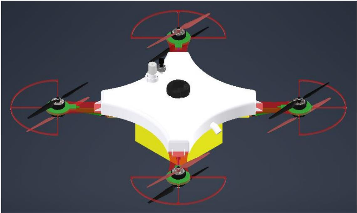
*Nota.* Diseño 3D de tanque de Payload instalado en la estructura del drone para fertilizar cultivos de café. Elaboración propia, realizado con Autodesk Inventor.
