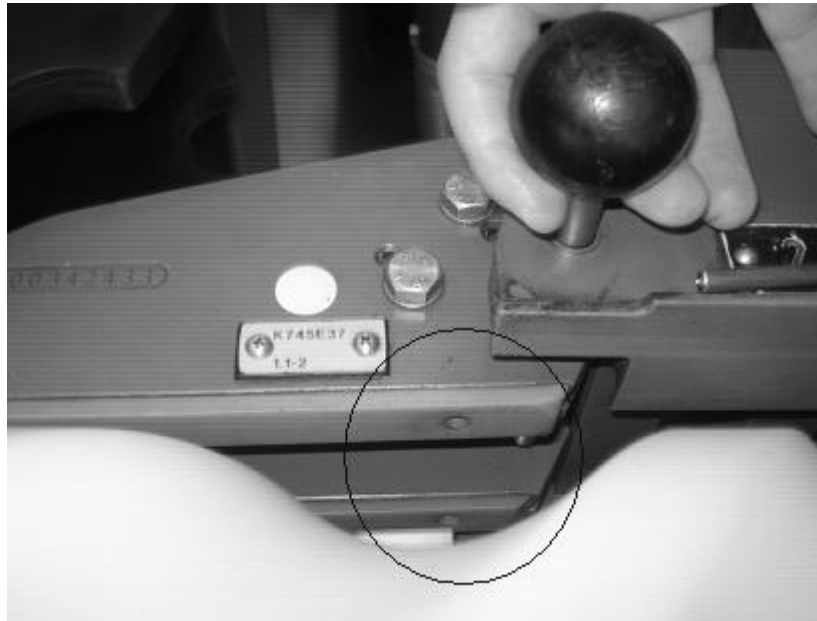
Figura 14. Perno para bloquear estrella
