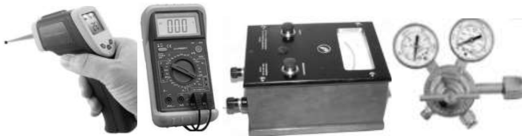
Figura 35. Equipos usados para comprobación de ausencia de energía en Agregados de Guatemala S. A.
