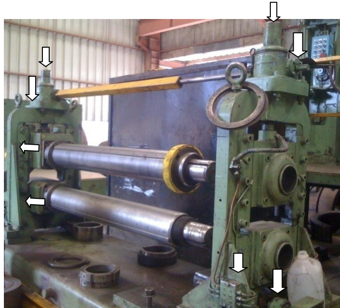
Figura 23. Puntos de lubricación de pinch roll
