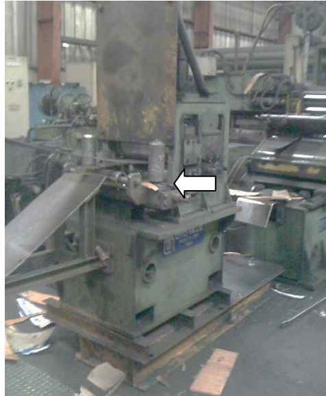
Figura 33. Ubicación de engrase pinch roll allanadora
