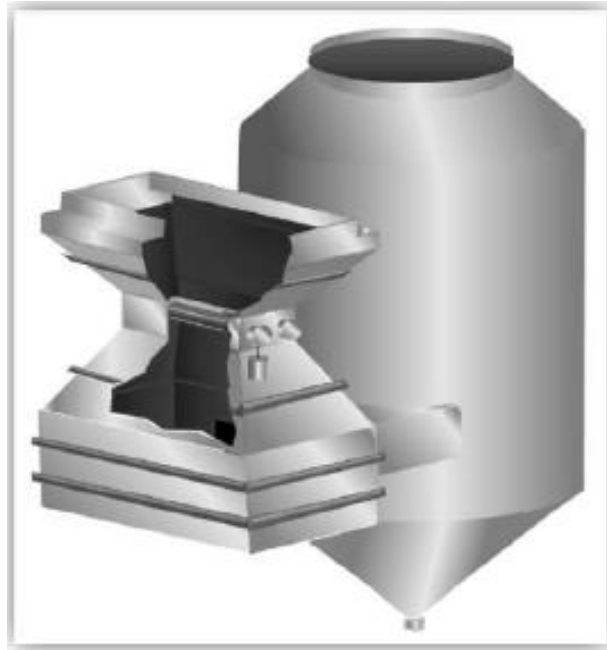
Figura 33. Torres rociadoras I
