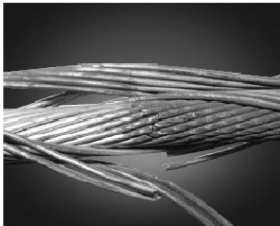
Figura 19. Daño en un conductor debido a las vibraciones provocadas por el viento
