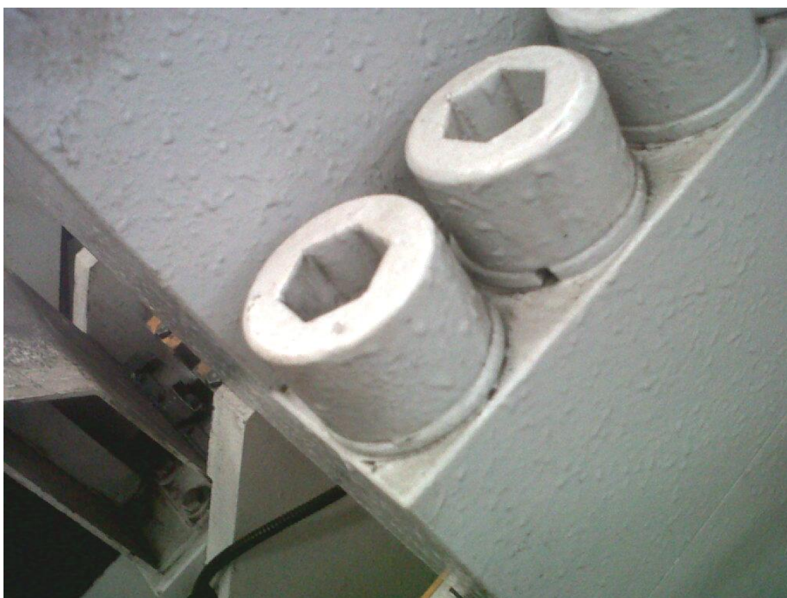
Figura 21. Tornillos para llave hexagonal
