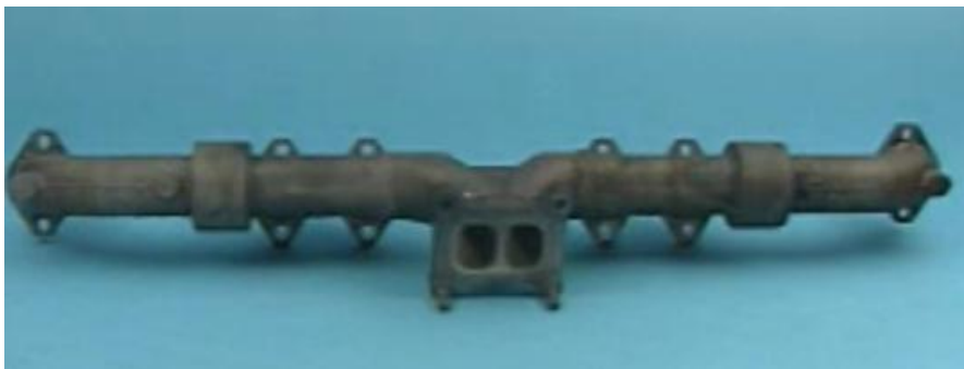
Figura 51. Múltiple de escape diseño de gases pulsantes
