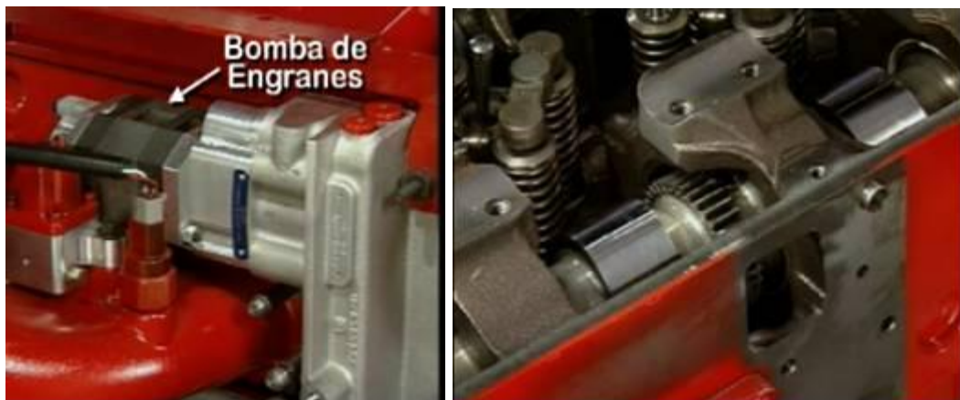
Figura 107. Bomba de engranes y acople en árbol de levas de inyectores
