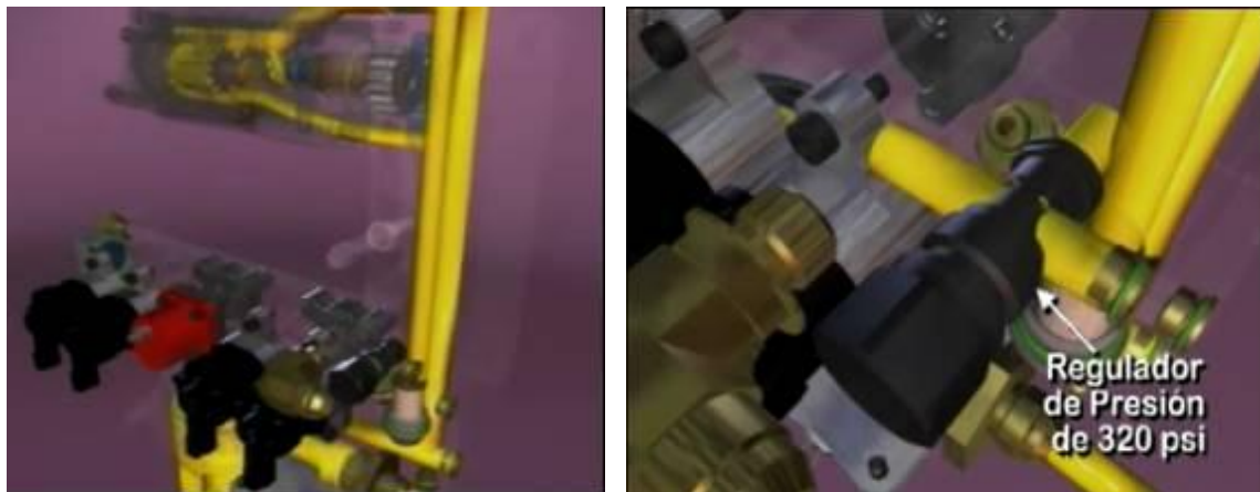
Figura 123. Primera etapa de regulación de combustible
