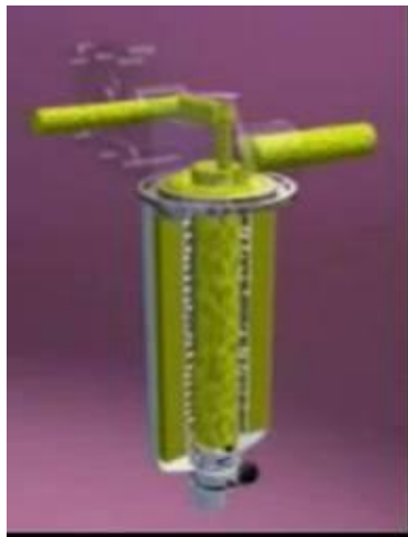
Figura 75. Filtración de combustible
