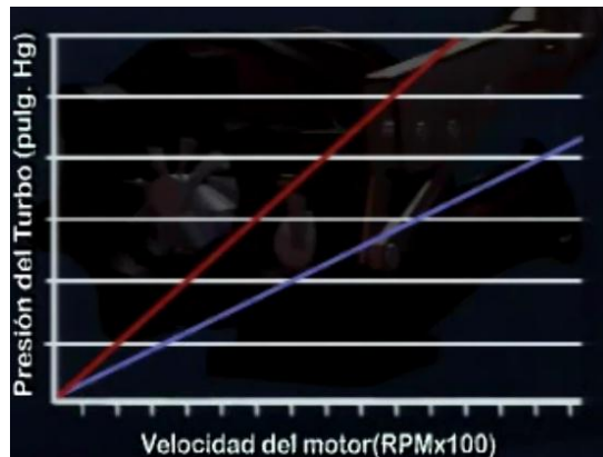
Figura 57. Gráfica del incremento de presión del turbocompresor de mayor capacidad
