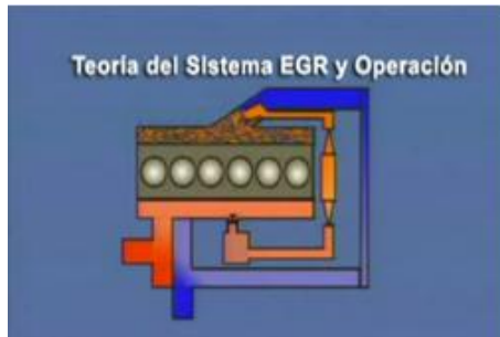
Figura 164. Esquema de sistema EGR
