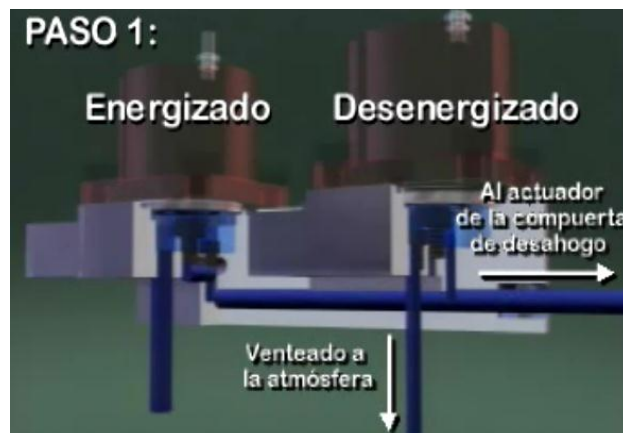
Figura 65. Control de desahogo paso 1
