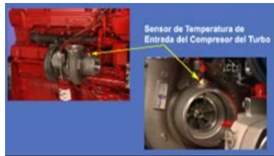
Figura 175. Sensor de temperatura de gases
