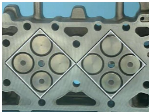
Figura 50. Arreglo de válvulas
