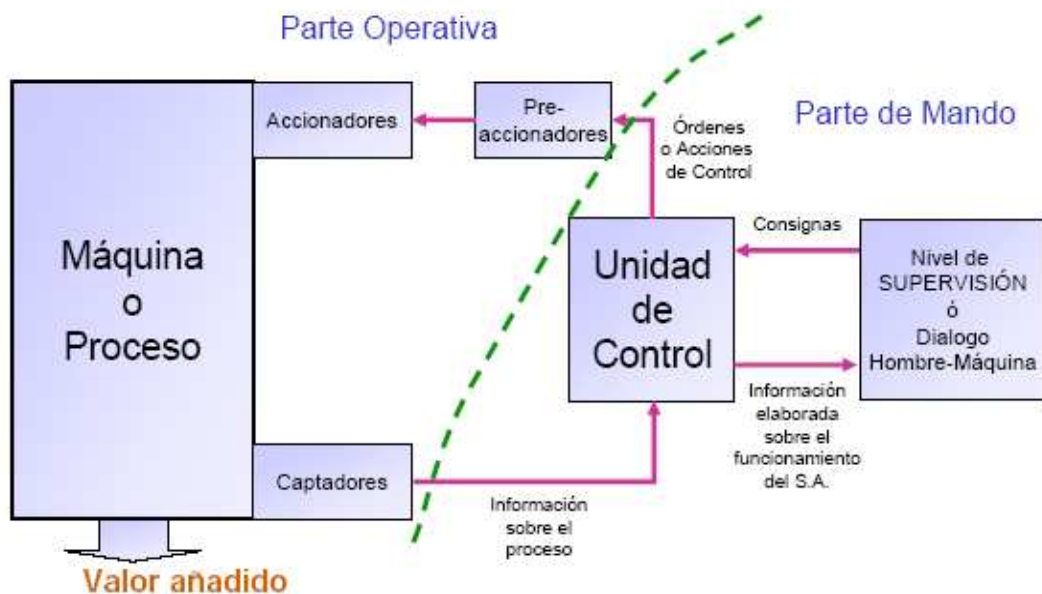
Figura 8. Componentes de un sistema automatizado
