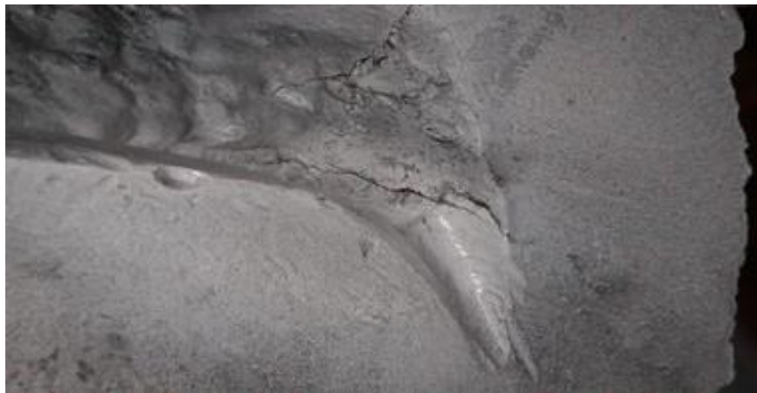
Figura 13. Falla original de swing-lever . Revelación por partículas magnéticas
