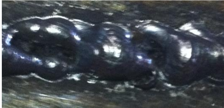
Figura 30. Electrodo E6013 amp. 75
