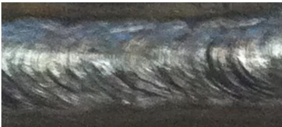
Figura 28. Electrodo E7018 amp. 150
