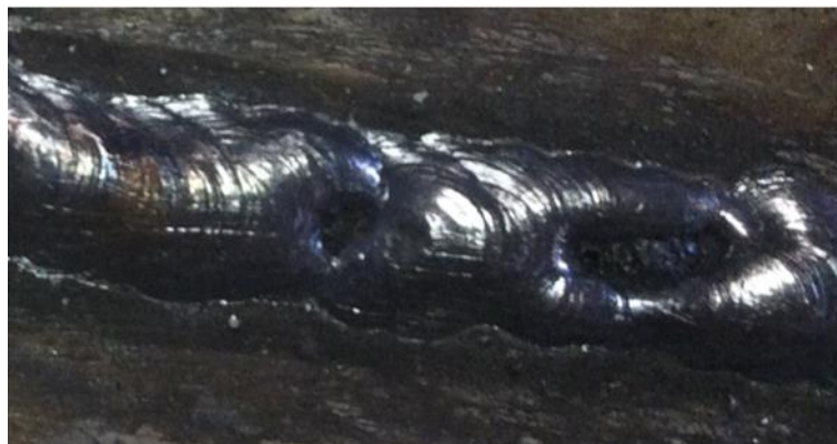
Figura 31. Electrodo E6013 amp. 85
