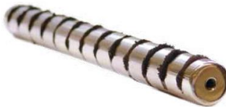
b) Barra imantada reteniendo partículas metálicas.
