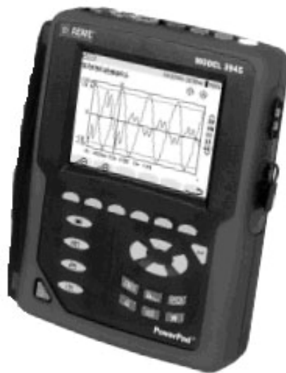
Figura 23. Analizador de calidad de potencia
