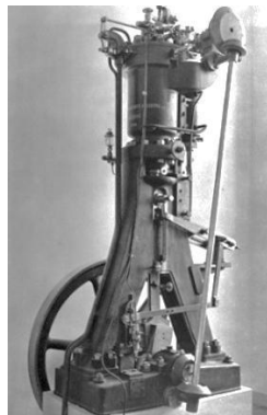
Figura 2. Motor diésel fabricado por Rudolf Diesel en 1892
