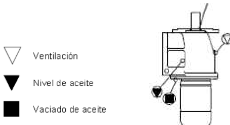
Figura 61. Nomenclatura de ventilación, nivel de aceite y vaciado de aceite
