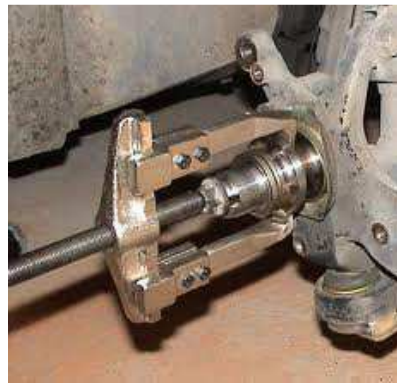
Figura 53. Extracción de rodamientos
