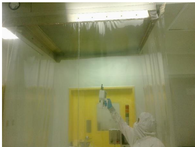
Figura 53. Contador de partículas bajo la campana de flujo laminar
