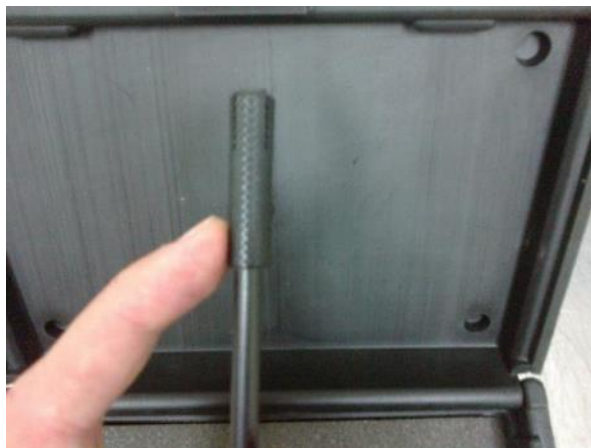
Figura 111. Tapón del terminal en posición cerrado
