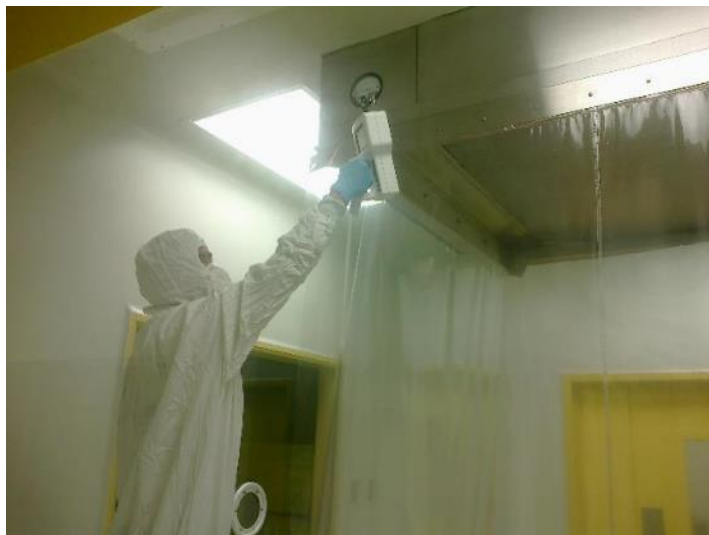
Figura 86. Medición en las juntas de estanqueidad (II)
