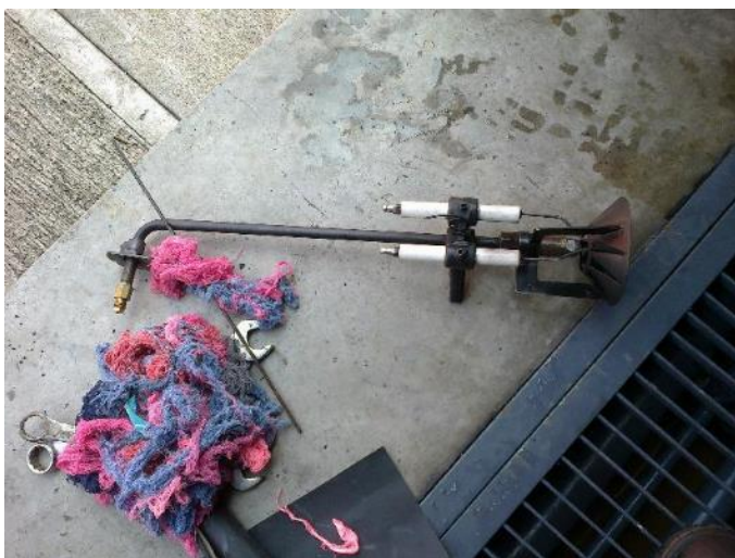
Figura 127. Quemador con dos electrodos
