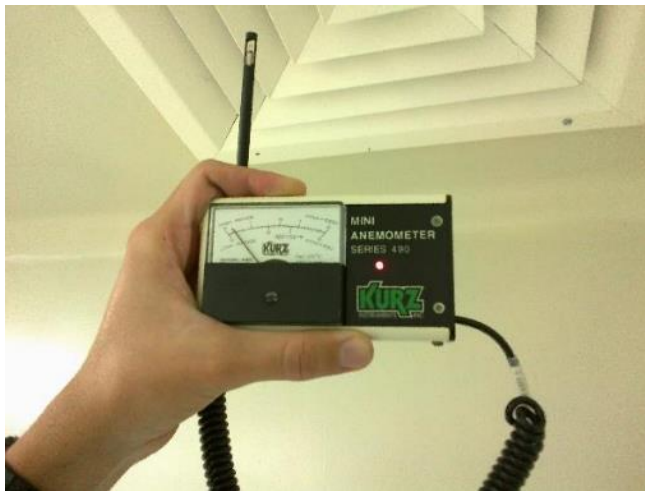
Figura 114. Medición de caudal (I)
