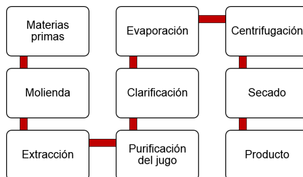
Figura 5. Proceso global de un ingenio de azúcar
