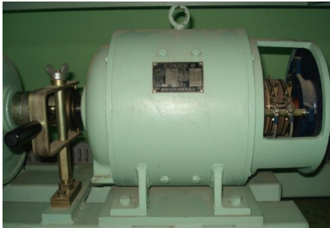
Figura 3. Generador síncrono del M-G parte frontal
