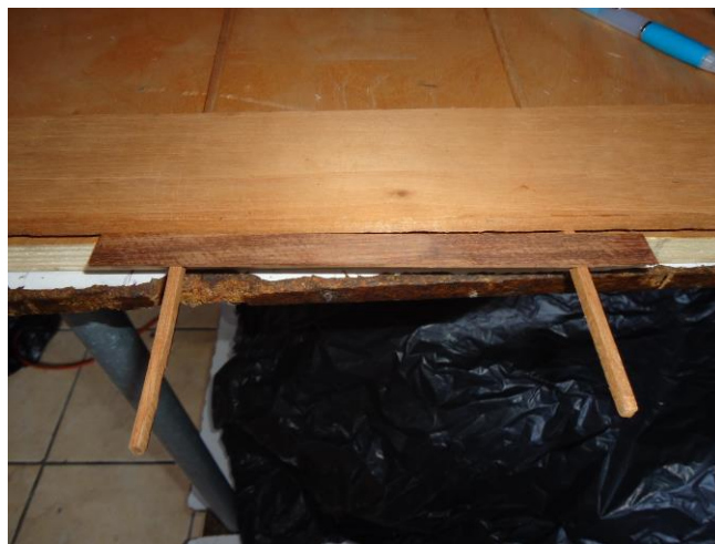
Figura 16. Testigo sobre dos reglas a una distancia 150 milímetros
