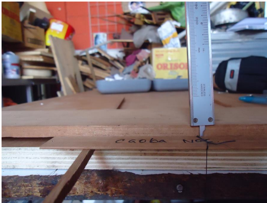
Figura 17. Medición de testigo con pie de rey
