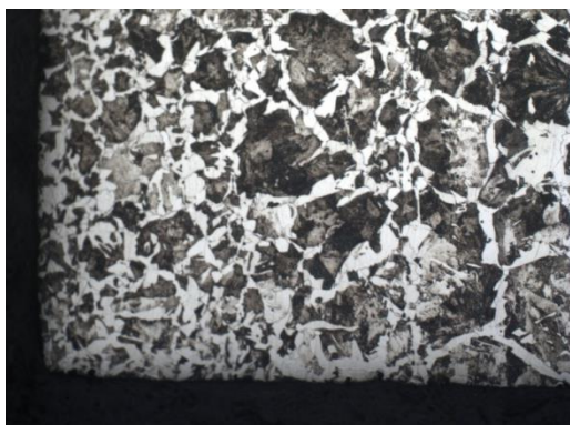
Borde, Tamaño de grano ASTM N°4 de la ferrita; x100
