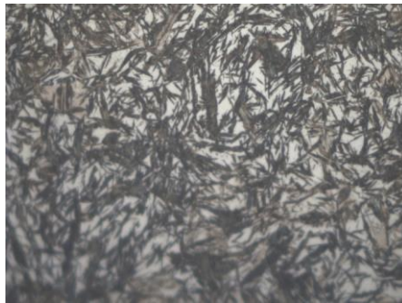
Figura 12. Martensita (agujas aciculares negras) sobre una matriz de austenita retenida (blanco), acero DIN 16CrNi4, cementada y templada en aceite, Nital 2%. x1000
