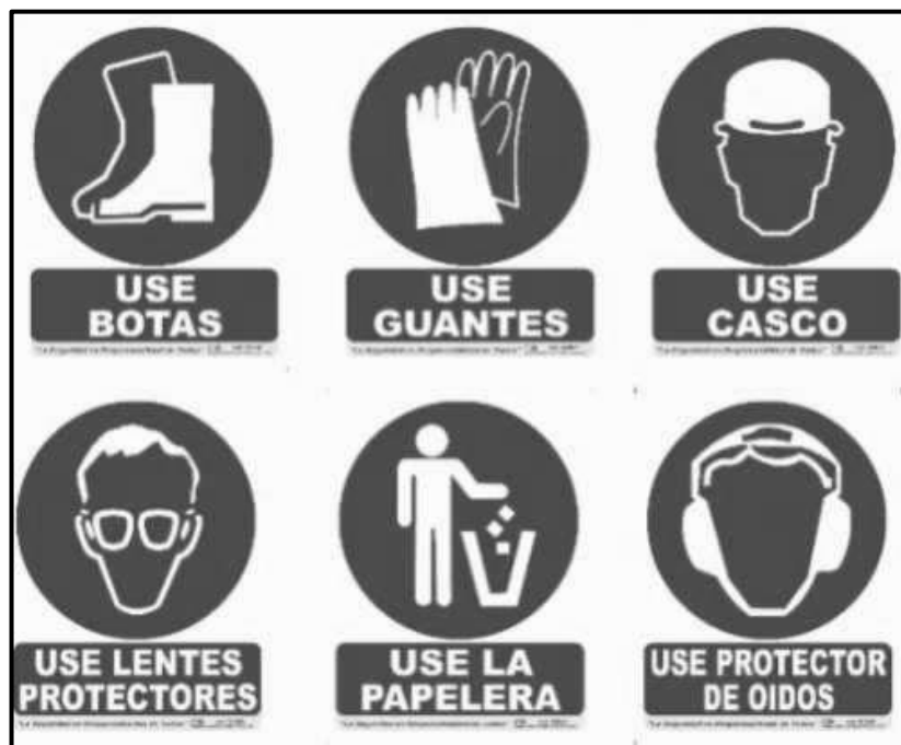
Figura 26. Señales de elementos de protección personal
