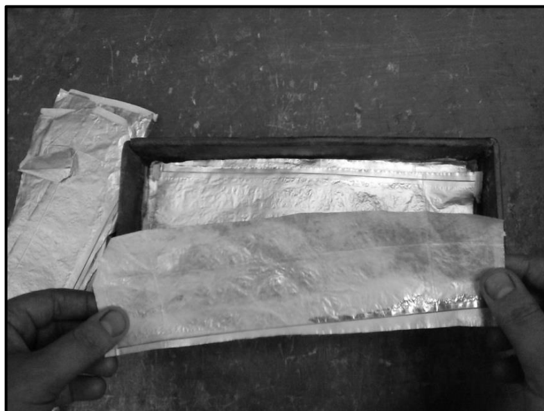
Figura 42. Colocación de láminas de polialuminio en molde
