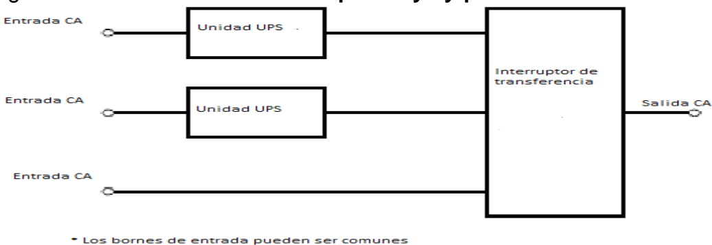
Figura 70 SAI con redundancia pasiva y by-pass
