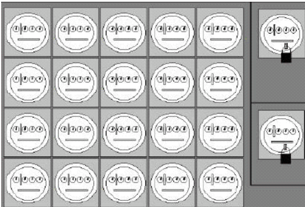
Figura 20 Armario tableros múltiples de contadores y medición en caja tipo III
