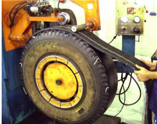
Figura 15. Proceso de reencauche de neumático
