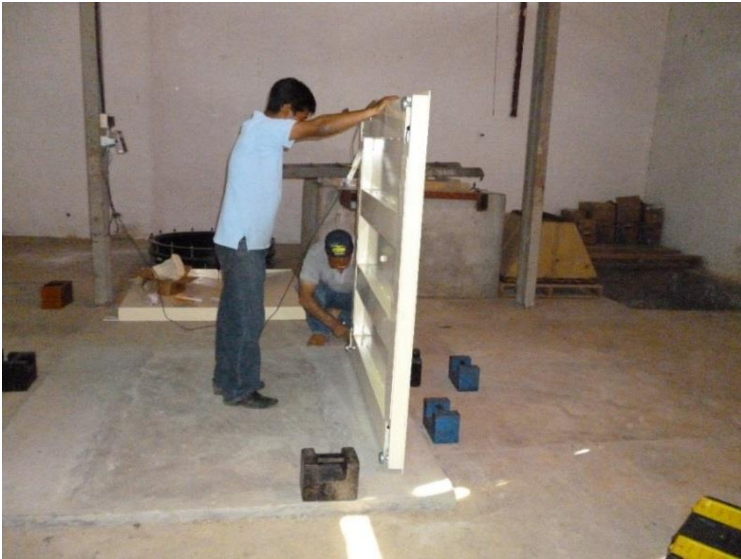
Figura 4. Montaje de instrumentos de pesaje industriales
