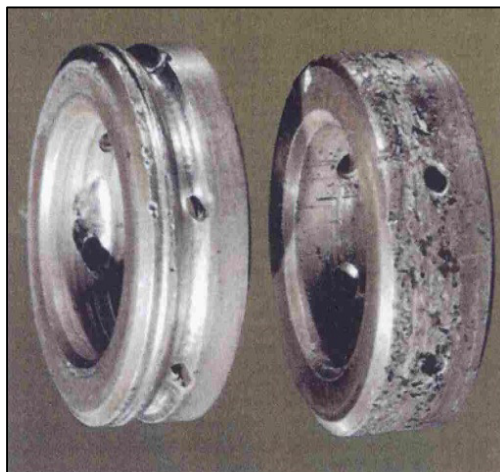
Figura 21. Ralladuras profundas y daños en los orificios de aceite de los cojinetes
