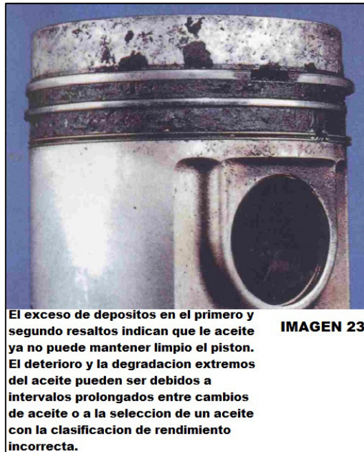
Figura 20. Exceso de depósitos en primer y segundos resaltos
