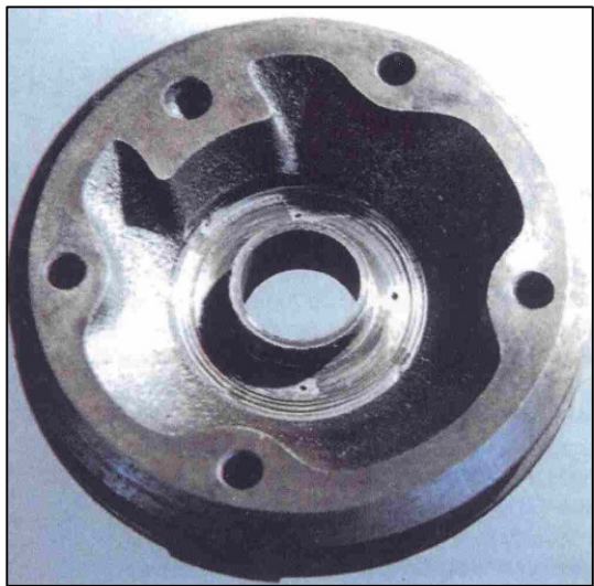
Figura 25. Ranuras de desgaste en las superficies de las arandelas de tope
