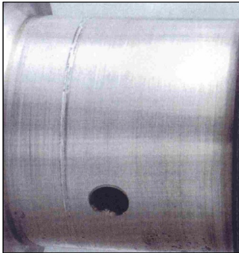
Figura 15. Arañazos profundos a lo largo de la circunferencia; efecto de partículas abrasivas en superficie del cojinete
