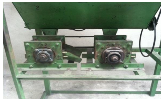
Figura 15. Vista de chumaceras tipo brida de rodillo de molienda, área de molido final
