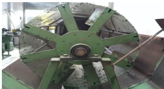
Figura 46. Vista externa de chumacera tipo puente en estación 1
