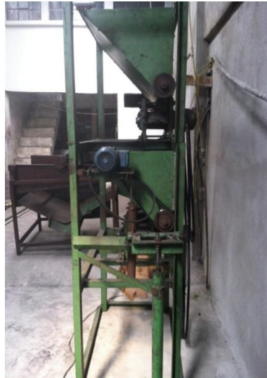
Figura 16. Vista de motor de transmisión para ejes de selección en área de premolido y molido final
