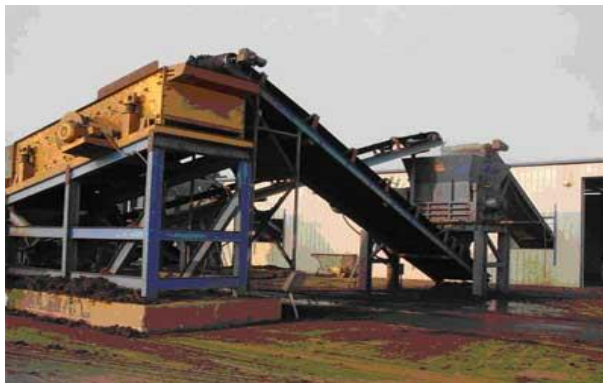
Figura 64. Vista de triturador de llantas
