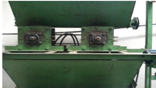
Figura 14. Vista de chumaceras tipo brida de rodillo de molienda, área de premolido
