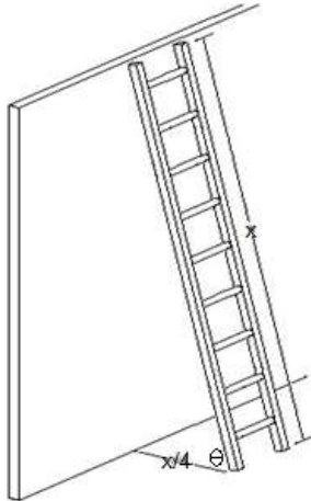
Figura 66. Disposición adecuada de una escalera
