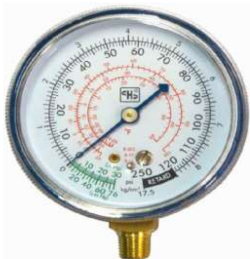
Figura 19. Manómetro de baja presión
