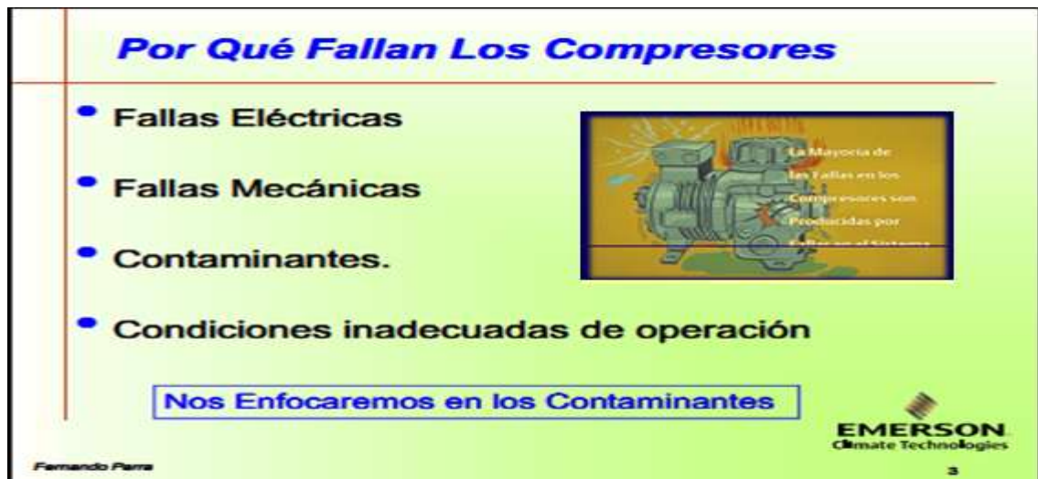
Figura 64. Fallas en los compresores
