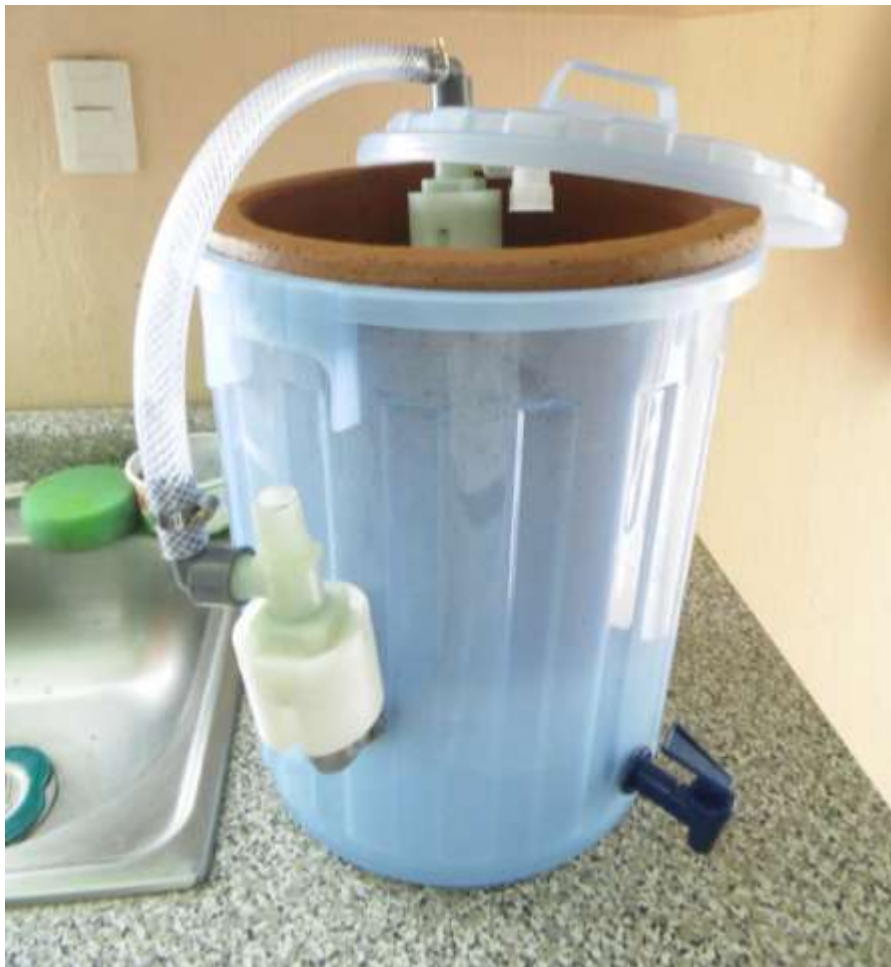
Figura 26. Equipo de purificación de agua sin conexión
