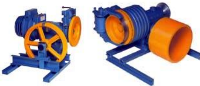
Figura 3. Grupos de tracción de una velocidad y dos velocidades
