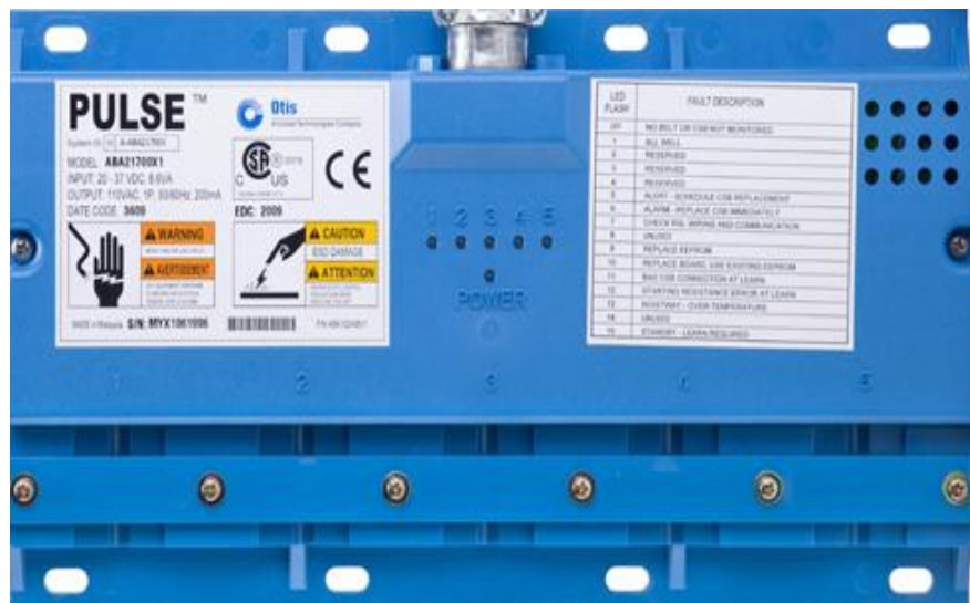
Figura 41. Inspector de resistencia utilizando el sistema Pulse
