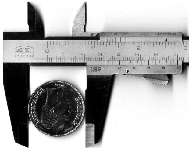
Figura 9. Medición de un diámetro con vernier
