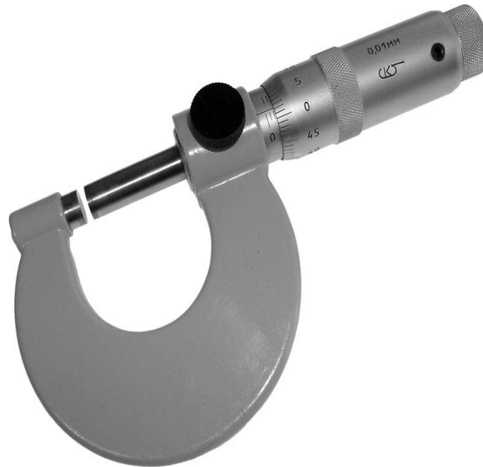
Figura 10. Imagen de calibrador palmer o micrómetro
