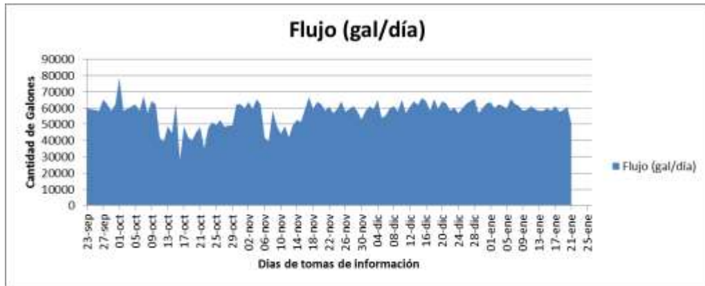
Figura 7. Flujo de agua de enfriamiento
