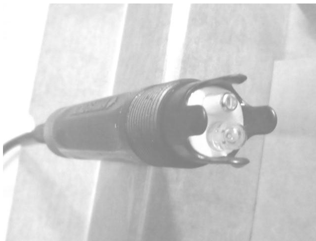
Figura 7. Electrodo de unión vidrio con sensor de temperatura para montaje en tubería
