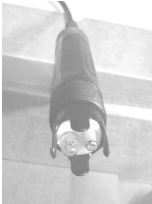
Figura 11. Electrodo con sensor de temperatura y rosca NPT.
