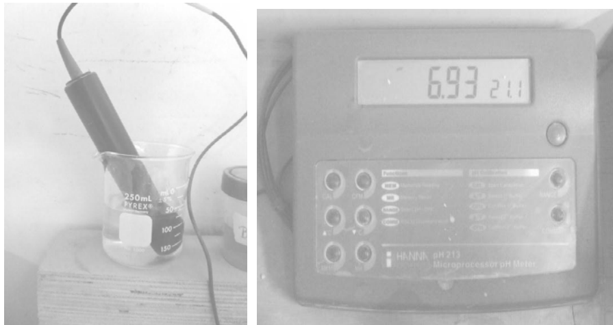
Figura 22. Electrodo y peachímetro marca HANNA
