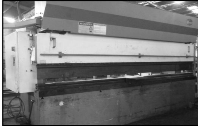
Figura 5. Dobladora de lámina Atlantic de 3/8"
