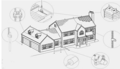
Figura 19. Sistema Franklin de protección con pararrayos
