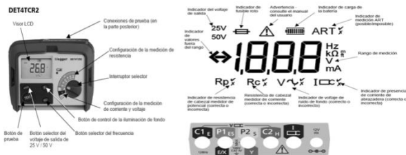
Figura 25. Descripciones de botonería e indicadores en la pantalla del Megger DET4TCR2
