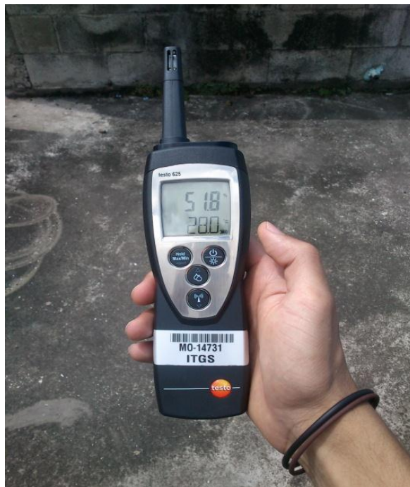
Figura 10. Medida de la humedad relativa en el exterior del recinto
