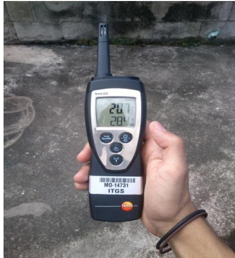
Figura 11. Medida de la temperatura de bulbo húmedo en el exterior del recinto
