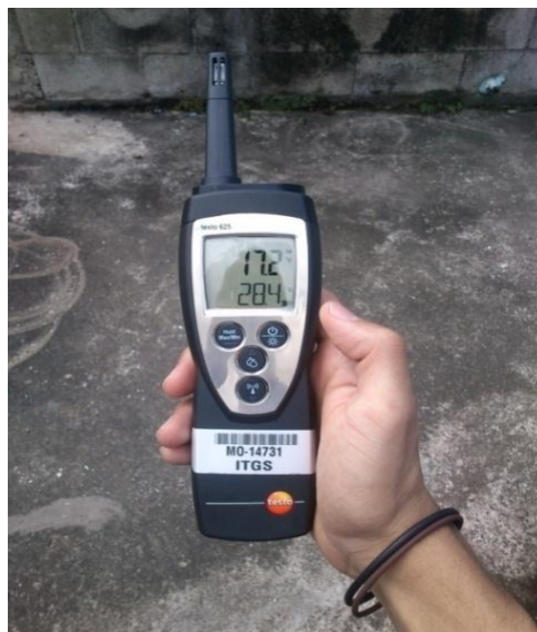
Figura 12. Medida de la temperatura de rocío en el exterior del recinto
