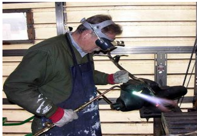
Figura 39. Ejemplo de soldadura oxiacetilénica
