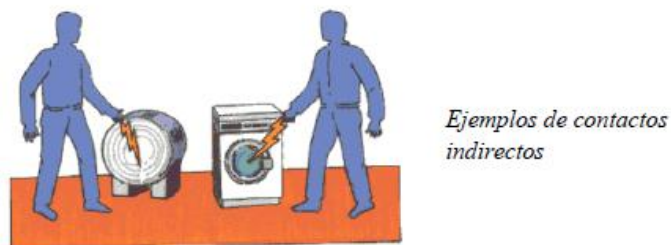
Figura 14. Contactos indirectos con equipos eléctricos
