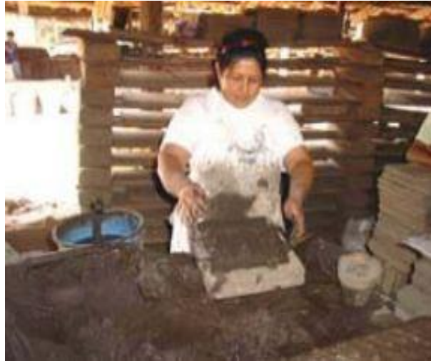
Figura 13. Llenado de gradilla (paso 1)
