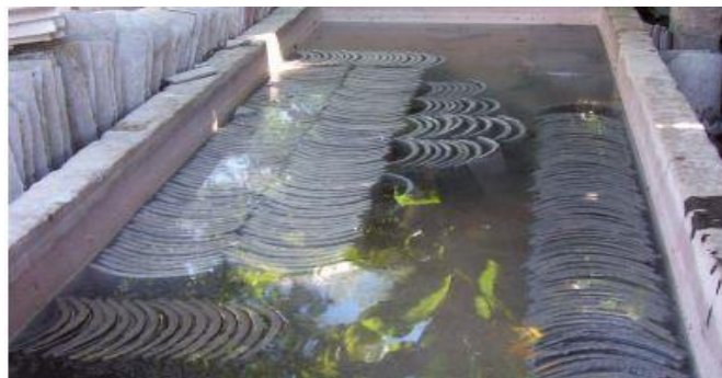
Figura 29. Fraguado de la teja
