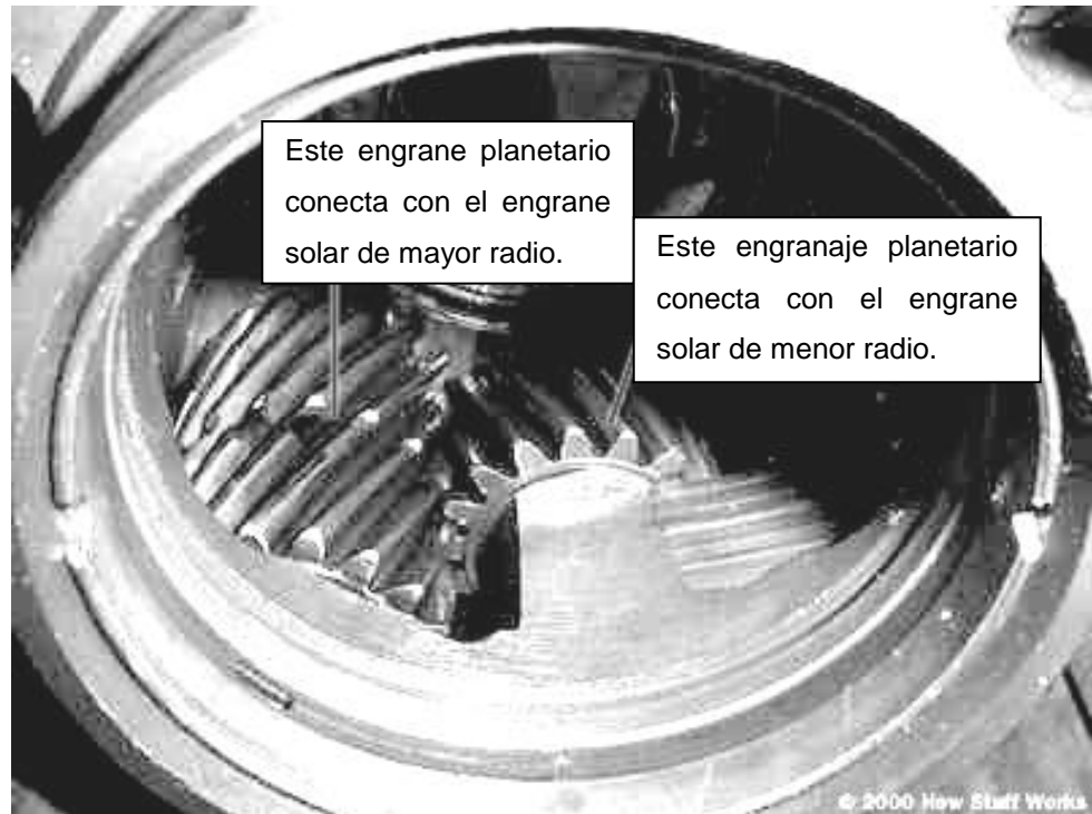
Figura 19. Sistema de engranes planetarios doble
