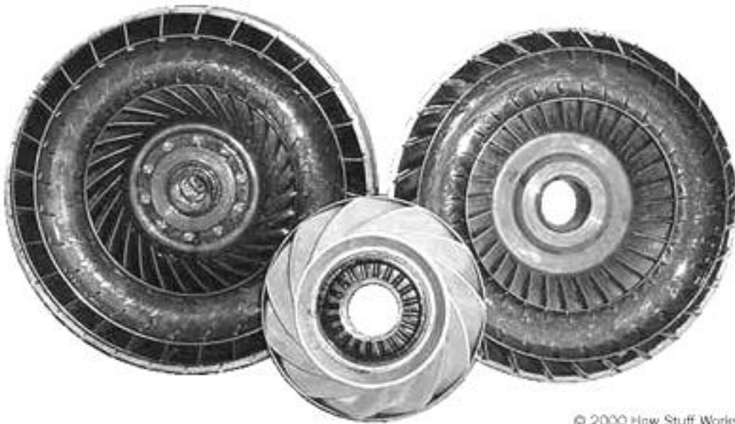
Turbina, estator y bomba (de izquierda a derecha)
