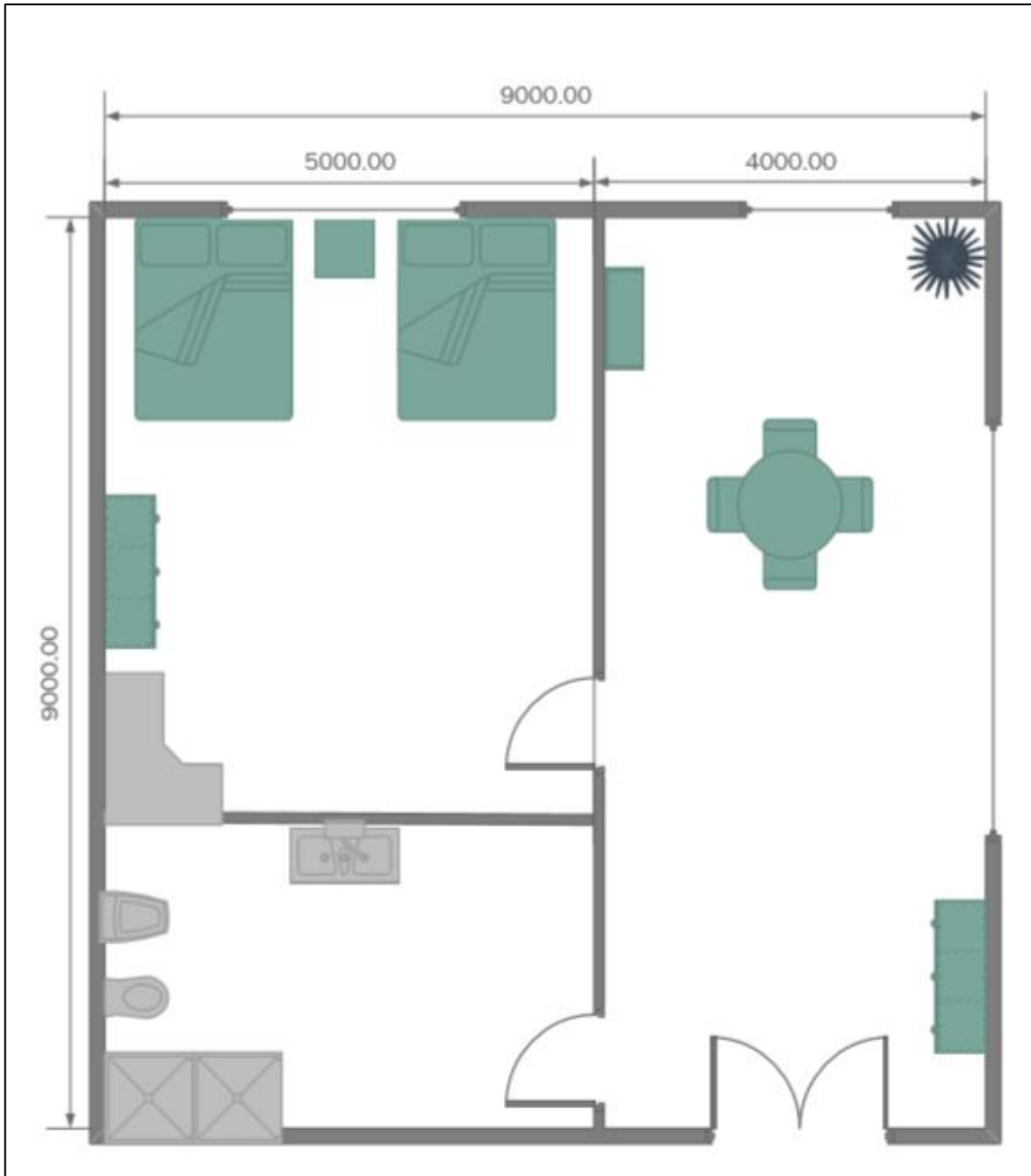
Figura 23. Cuarto triple en bungalow (medidas en milímetros)
