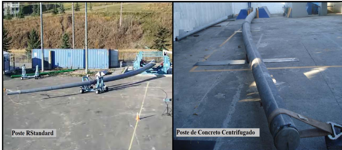
Figura 38. Deformación elástica de postes durante pruebas de ruptura
