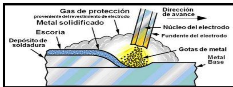
Figura 19. Soldadura de gas
