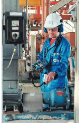
Figura 13. Ejemplo de ultrasonido a bomba de agua
