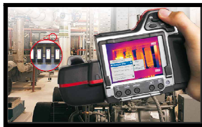
Figura 24. Ejemplo de aplicación de termografía
