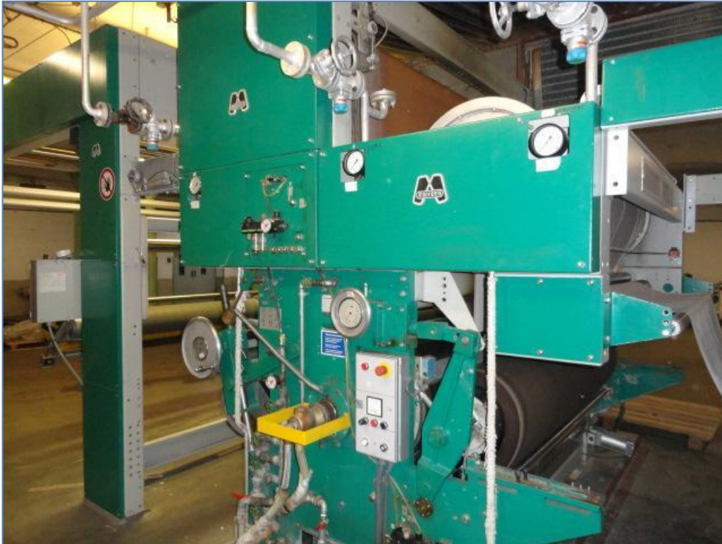
Figura 82. Trampeo en maquinaria multicilíndrica tipo secadora marca Monforts
