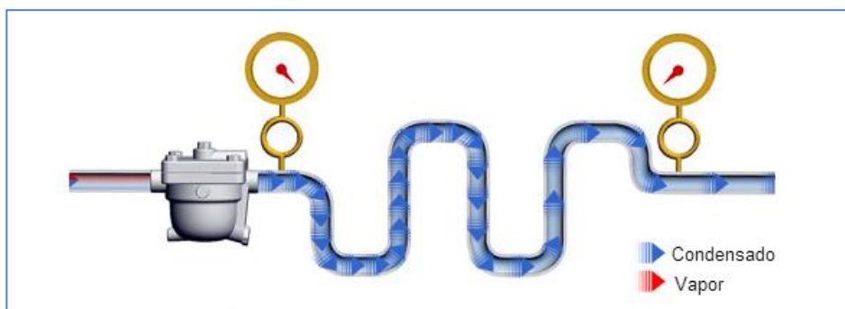
Figura 61. Condensado descargado a la atmosfera con cambios en tubería
