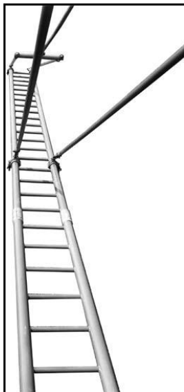
Figura 35. Escaleras de epoxiglas con empalmes
