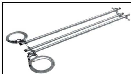
Figura 29. Cuna para aisladores de transmisión.
